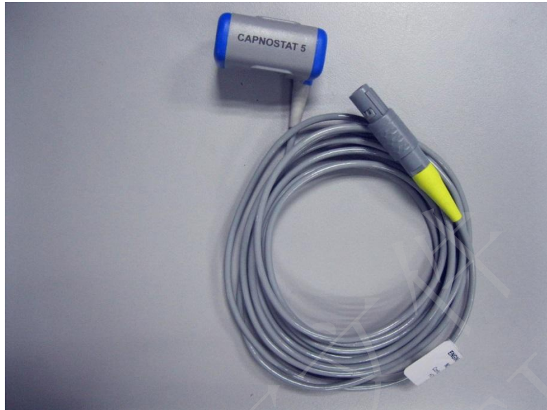
Módulo de flujo principal de CO 2 de Respirationics
